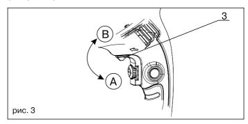
Изменение направления вращения возможно только на выключенном инструменте. Переключателем направления вращения **3** можно изменять направление вращения патрона. Положение **A** вращение по часовой стрелке. Применяется для сверления и завинчивания шурупов. Положение **B** вращение против часовой стрелки. Применяется для выворачивания винтов/шурупов и отвинчивания гаек.
